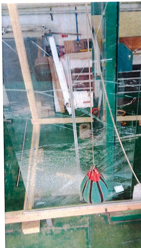
Fot.2. Uszkodzenie tafli szklanej po uderzeniu ciałem miękkim i ciężkim (50 kg) z energią 900 J
